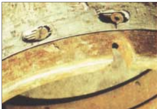
Растягивание внутреннего ролика привело к тому, что отверстия для стопорных винтов удлинились, и резьбовое крепление муфты ослабло.
